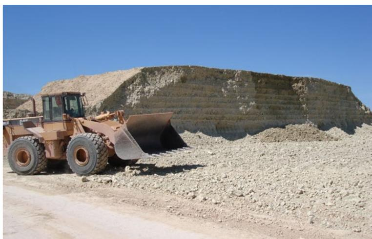
La **extracción de arcilla** es una parte esencial del proceso de fabricación de los materiales cerámicos que, inevitablemente, tiene impacto ambiental en las canteras. Pero, al mismo tiempo, es una actividad necesaria que **genera empleo y riqueza en áreas rurales** y permite fabricar materiales de origen natural como los cerámicos.
