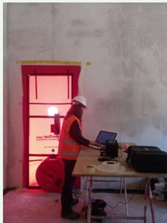
Izda. Prueba Blower-Door en la CTL Pasiva Positiva. Dcha. Fachada de muro de carga de bloque Termoarcilla vista desde el interior. Abajo: Fotos de la CTL Pasiva Positiva terminada
